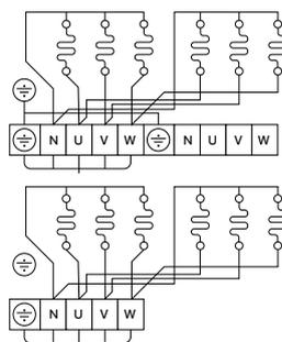
Если соединительный или монтажный кабель подходит к сауне, или сквозь стены сауны, на высоте более 500 мм, они должны выдерживать при полной нагрузке температуру 170 °С. Приборы, устанавливаемые на высоте более 500 мм от уровня пола сауны, должны быть пригодными для использования при температуре 125 °С (маркировка T125).
